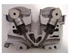
travaillent selon le principe des quatre temps: la force motrice du piston est effective à chaque deuxième rotation du vilebrequin. Les deux soupapes (d'admission et d'échappement) contrôlent l'échange du gaz. Elles s'ouvrent par le biais de l'arbre à cames et se referment sous l'action du ressort de soupape.
